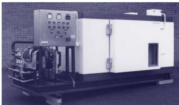
Figura 5. Túnel de congelación por aire forzado.
