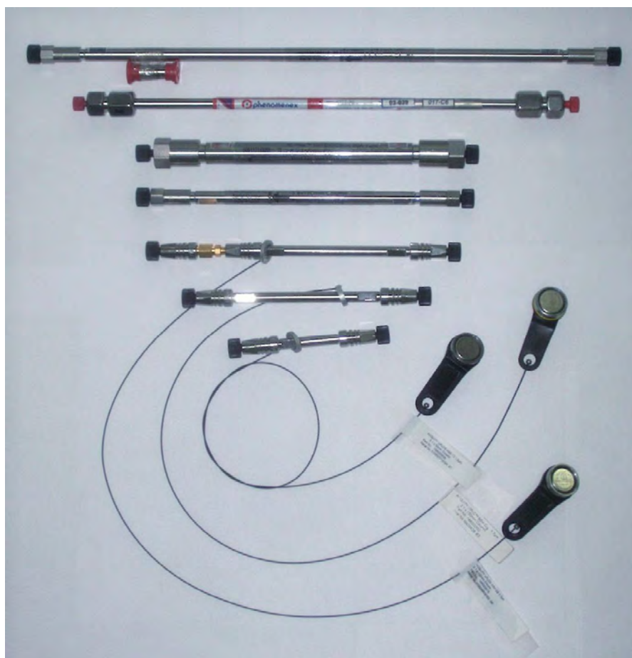
Figura 7. Columnas Cromatográficas longitudes 300 mm y precolumna, 250 mm, 150 mm, 150 mm, 100 mm y precolumna integrada, 100 mm y 50 mm, Diámetro Interno variable, las cuatro primeras utilizadas en análisis por HPLC y las tres últimas utilizadas en análisis por UPLC con tecnología e-coord.
