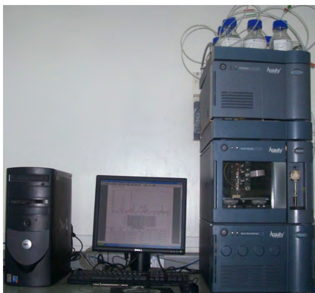
Figura 8. Acquity UPLC con detector de arreglo de diodos, bomba binaria automuestreador y horno para columnas.
