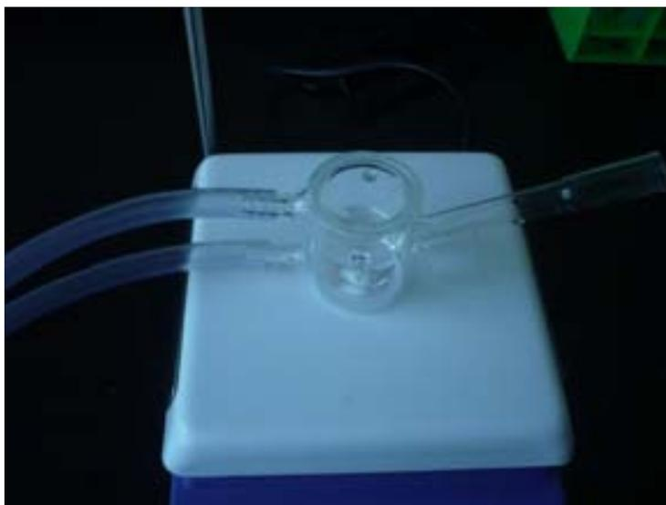
**FOTO 2:** Vaso termostatado sobre platina de agitación magnetica.
