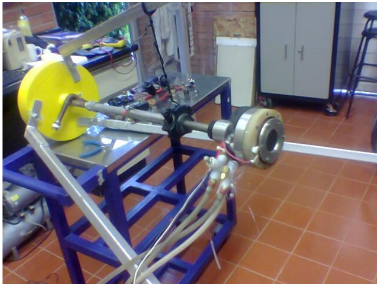
Figura 3.6. Imagen de cómo se instaló el sistema de generación eléctrica en el DEFAC.
