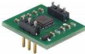
Figura 1.3.1 Sensor H48C de Parallax
