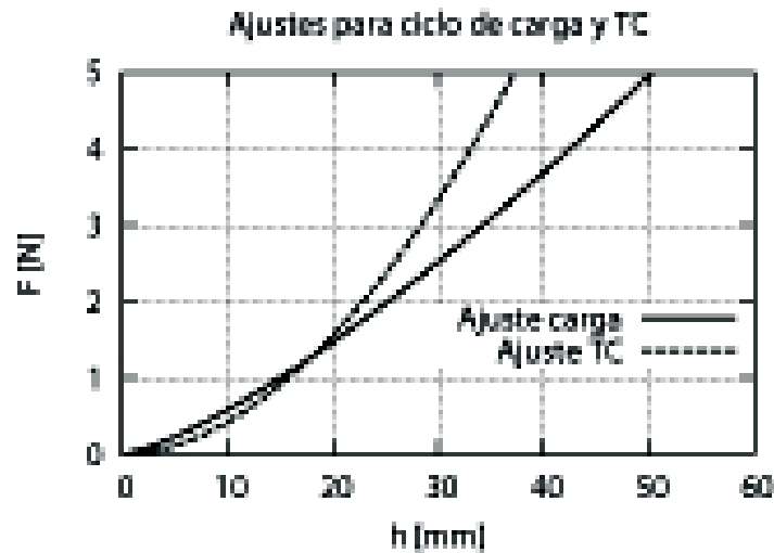
Figura 5.4: Comparación entre las funciones de ajuste para el ciclo completo de carga y para la zona correspondiente a la TC.
