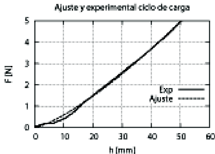
Figura 5.3: Curva de carga experimental con la curva de ajuste superpuesta. Se aprecia cómo es que la curva ajustada presenta una desviación significativa en la parte correspondiente a la TC, dentro de los primeros \sim 17\mu\text{m} .
