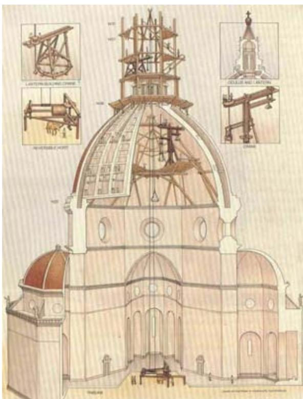
**Fig. Nº 15 Brunelleschi tuvo el cuidado de diseñar un andamio que no tocara las paredes de la cúpula para no tener que empotrar mechinales en ésta.**
