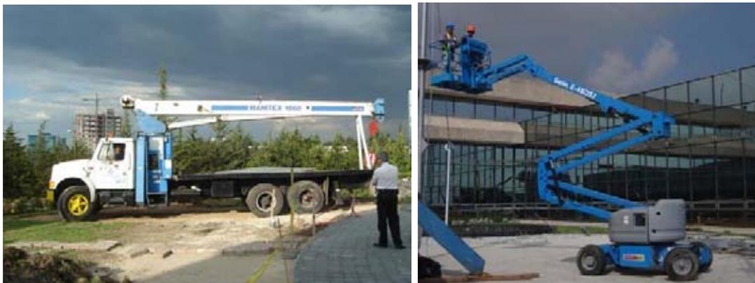
**Figs. Nº 103 y 104 Grúa” Manitex” de 12 tons y elevador de canastilla “Genie”.**
