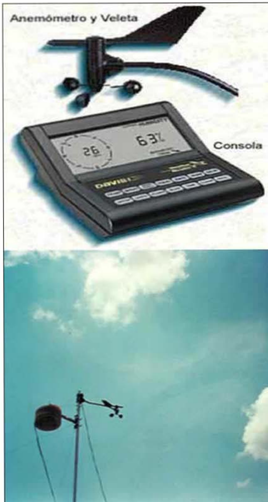
Figura 5.1.A.4. Estación de meteorología (Marca Davis Instrument)
