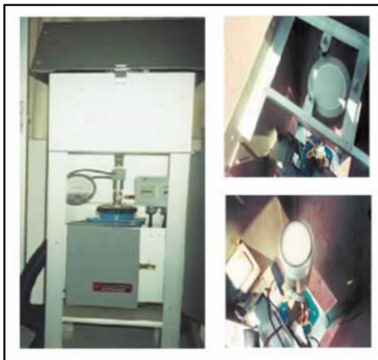
Figura 4.1.A.1. Muestreador Hi-Vol modificado para HPA's del aire
