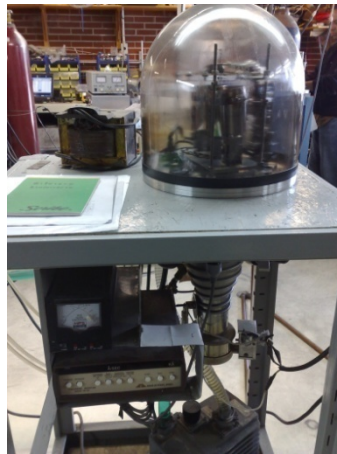
Figura 4.3. Evaporadora utilizada para la fabricación de los electrodos de la plata.
