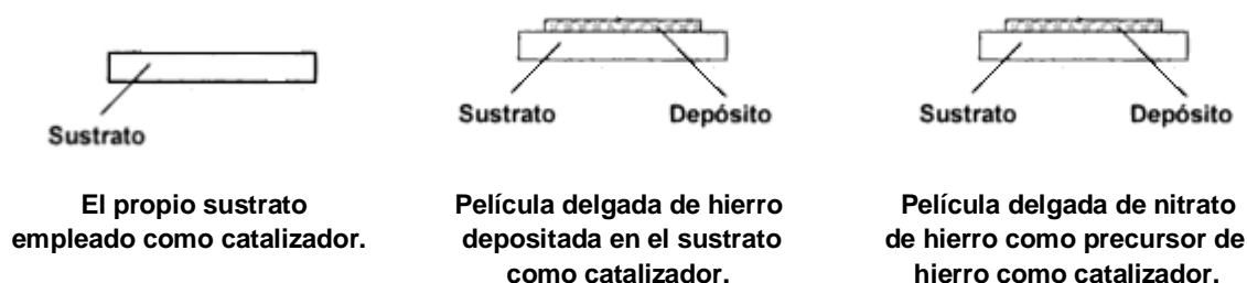
Figura 9: Variantes de catalizador empleados en este trabajo para la síntesis de los NTCs.
