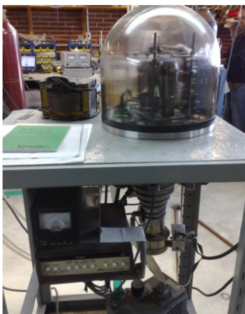
Figura 23. Sistema de evaporación empleado para el depósito de películas delgadas de hierro.
