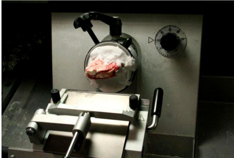
FIGURA 22. Tejido montado en el criostato para ser seccionado a 20 \mu\text{m} de grosor.
