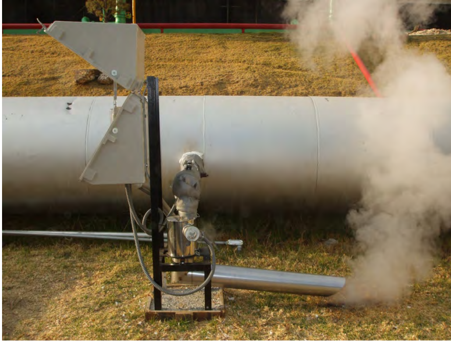
Figura 5.1 Medición de la entalpía
