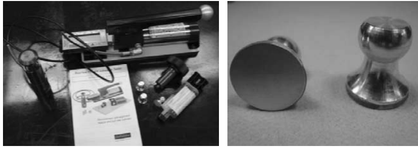
Figura III.19 Adhesímetro digital marca Poliest para la prueba pull-of y probetas de prueba ( oll ) de 20 mm de diámetro.
