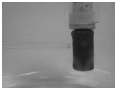
Figura III.16 Tubo Luggin en la celda electroquímica.
