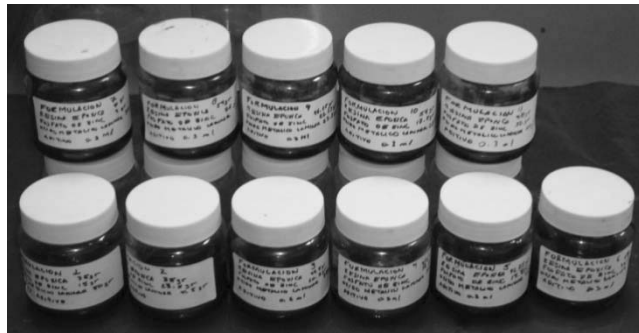
Figura III.13 Almacenamiento e identificación de los 11 sistemas de pintura.
