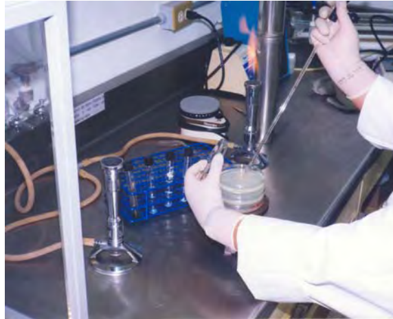
Figura IV.10 Siembra en cajas de Petri para cuantificación de bacterias totales heterótrofas
