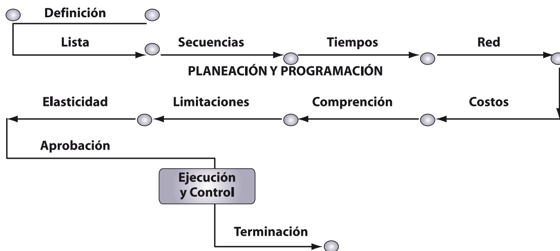
Figura 3.6. Fases del proceso del Método de la Ruta Crítica
