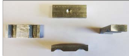
Figura 3.30 Distribuidores de fuerza.
