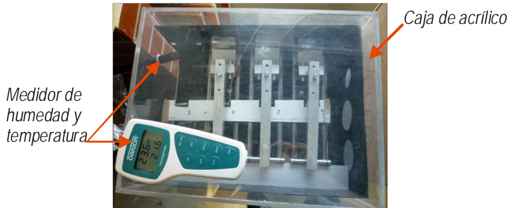
3.21 Sistema de control atmosférico
