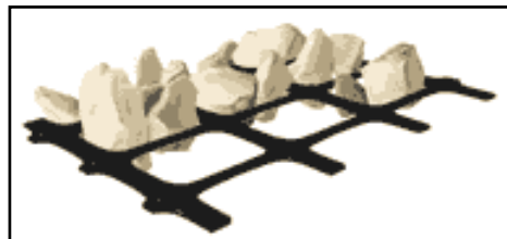
FIG. 2.19 ENCASTRADO DE LOS GRANULOS EN LAS ABERTURAS DE LA GEOMALLA
