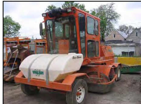
FIG. 3.8 BARREDORA CON TANQUE DE AGUA AL FRENTE
