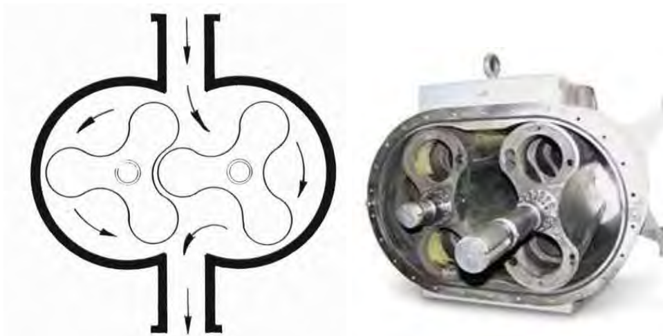
Funcionamiento de un soplador tipo lobular y Soplador Tipo (3)
