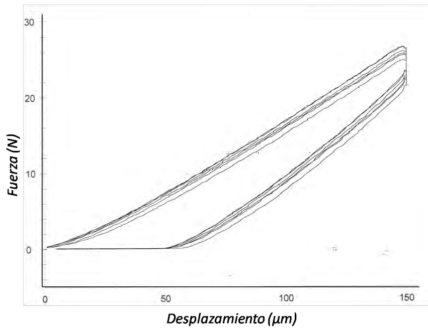
Figura 5.39 Perfiles de dureza de indentación para 6 compactos de PCM, compactos formados a partir de 127 MPa como presión de compactación. Curva fuerza-desplazamiento.
