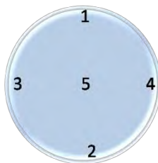
Figura 4.5 Orden de las mediciones efectuadas en el compacto.
