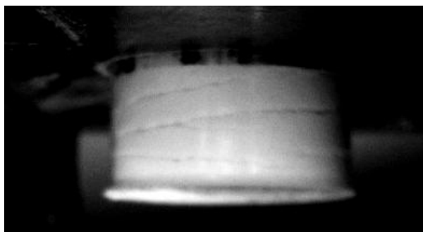
Figura 5.28 Laminación presente en un compacto de PCM, justo al momento de la eyección.
