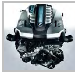
Figura 3.1- Hydrogen 7 concebido por BMW, motor bivalente capaz de funcionar con hidrógeno y gasolina (Clean Energy BMW Group, 2007)
