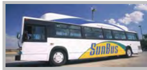
Figura 3.4- Autobús propulsado con la mezcla comercial Hythane (Lanz y col., 2001)
