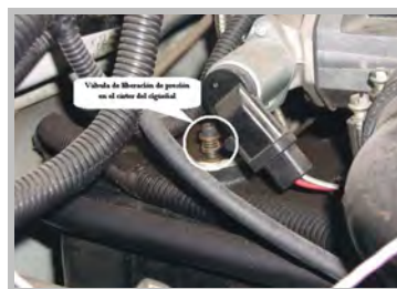
Figura 3.3- Válvula de liberación de presión (adaptada de Lanz y col., 2001)
