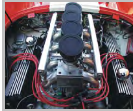
Figura 3.2- Motor de combustión interna alimentado con hidrógeno (Lanz y col., 2001)
