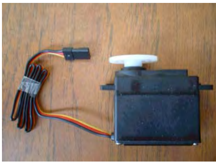
a) Servomotor de modelismo ensamblado
