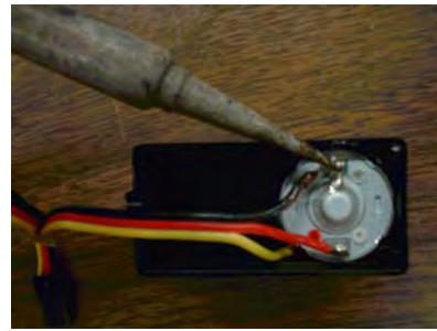
b) Cables para la alimentación del motor
