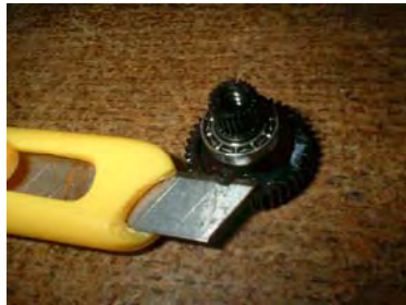
b) Corte del tope de plástico
