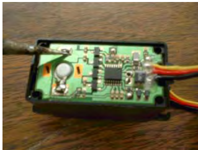
a) Desoldado del motor
