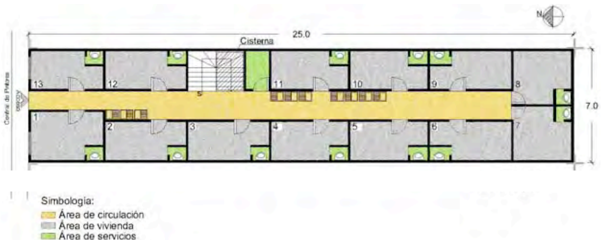
Plano 3. Planta arquitectónica de vecindad. Planta Baja.
