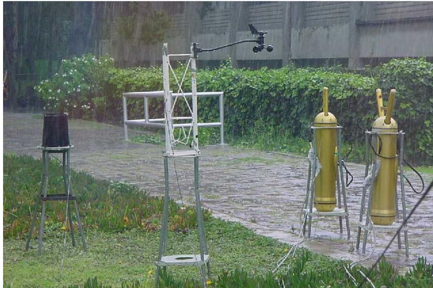
Figura 4.5. La imagen muestra los dos espectrómetros 2D en posición vertical para el muestreo de gotas de precipitación en fijo. También se pueden ver la estación meteorológica cerca de los instrumentos.
