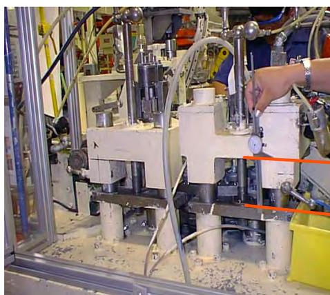
**AJUSTE DE ALTURA EN LA ESTACION DE CORTE**
