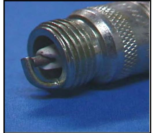
Figura 2.5 Defecto de punta de encendido rota
