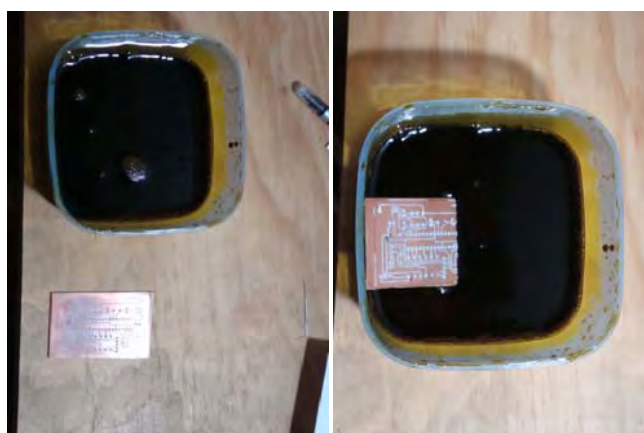
Figura 2.25. Revelado del circuito.
