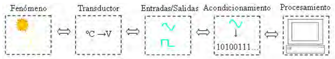
Figura 1.1. Esquema que ejemplifica la adquisición de datos
