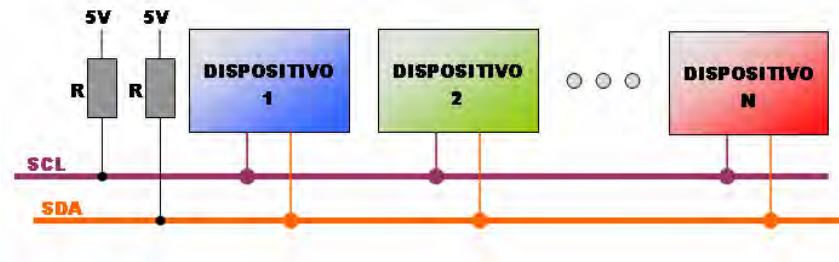
Figura 2.20. Conexión de dispositivos en el I^2C .
