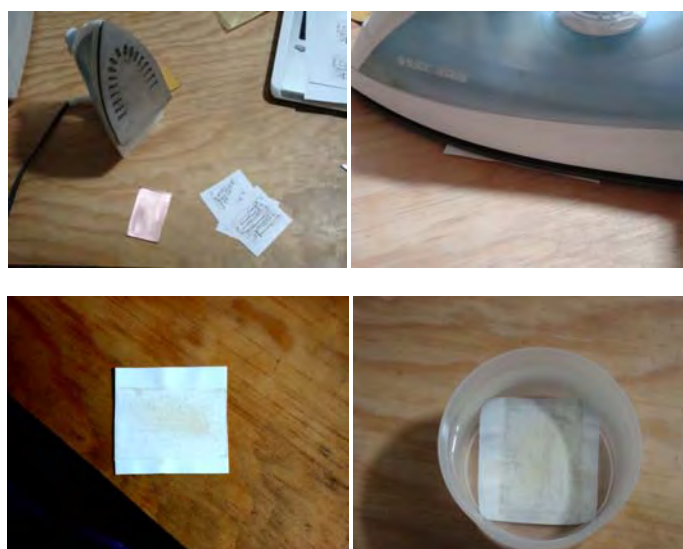
Figura 2.24. Procedimiento del planchado.
