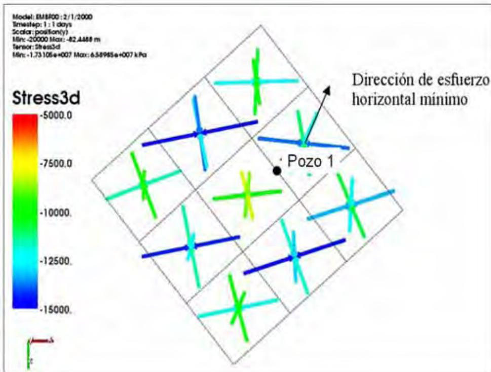
Figura 5.7 – Dirección del esfuerzo en la capa k=11, profundidad 1562m, Caso actualizado u006.
