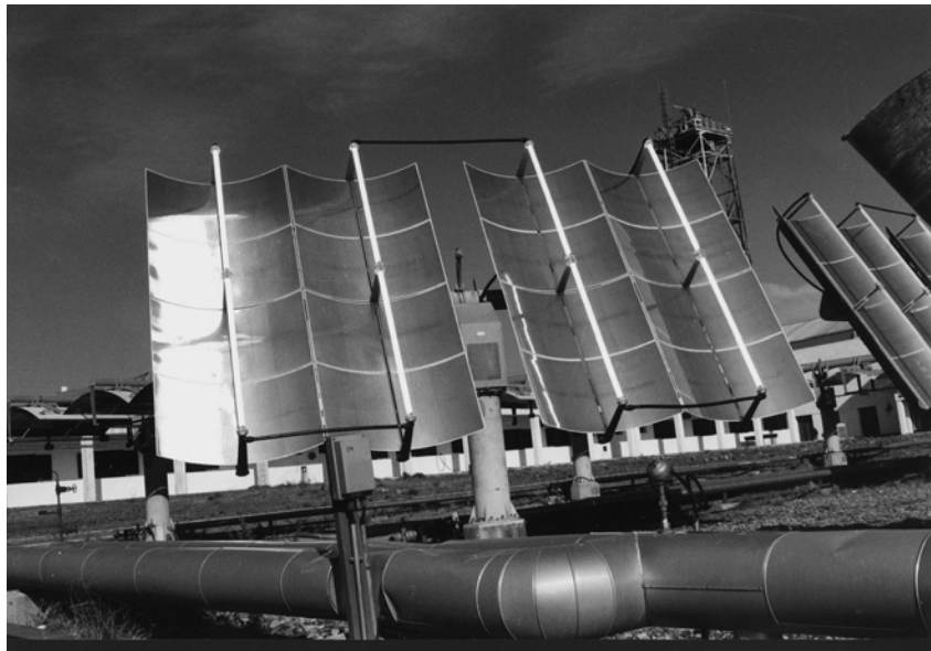
Fig. 1.8: Fotografía de un Reactor de Canal Parabólico, instalado en la Plataforma Solar de Almería [38].
