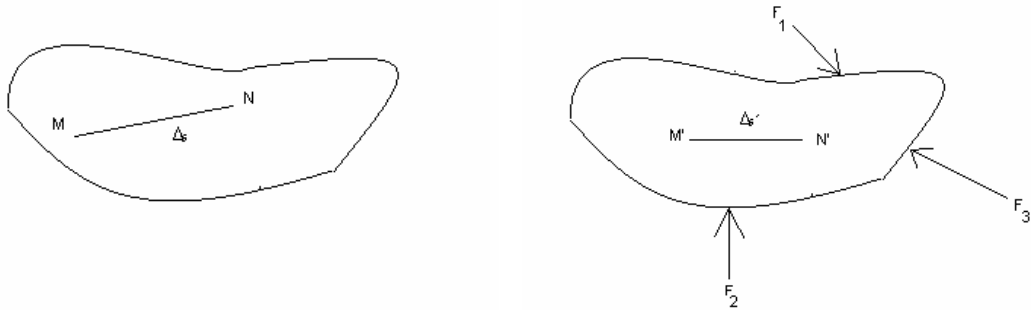
Figura 1.3.1-1. Cambio de longitud entre dos puntos internos debido a fuerzas externas
