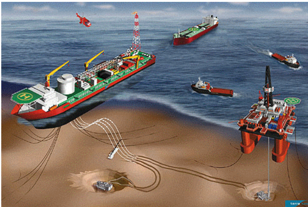
Unidad Flotante de producción, almacenamiento y descarga (FPSO)
