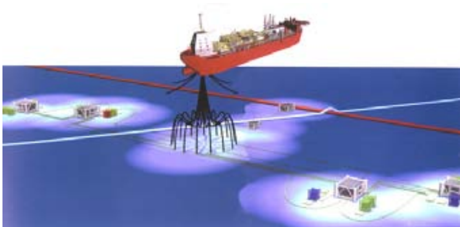
Esquema de desarrollo del campo, mostrando la posición del FPSO sobre dos Clusters.
