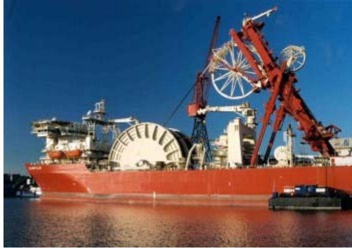
II. Barco de tendido de línea tipo "J".
