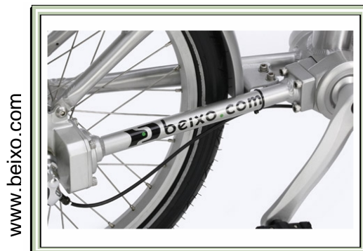
Figura 1.12 Transmisión manual por cardán.
