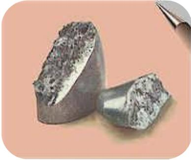
Fig.31 ITRIO, estabilizador del óxido de zirconio<sup>11</sup>
