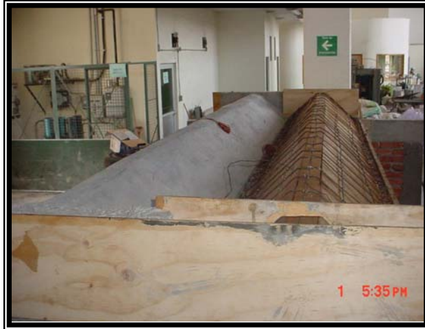
Figura B.2. Modelo del sistema de 9 placas plegadas ensayado en la UAEM, con la mitad de la sección terminada. (Dr. Horacio Ramírez de Alba).
