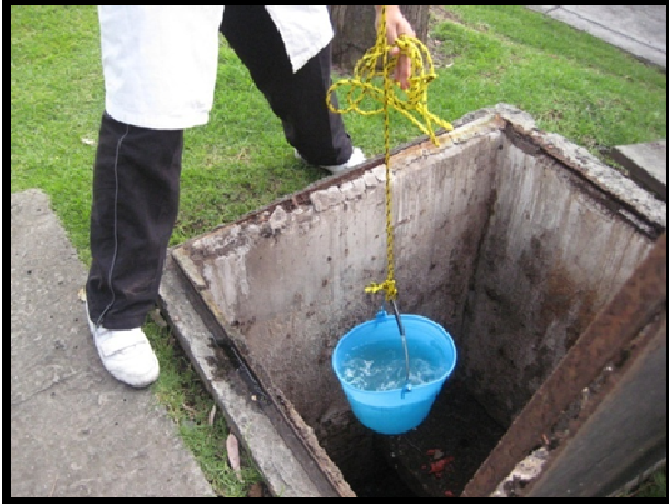
Figura-15 Muestreo en la cámara de agua tratada de una PTAR BRAIN
