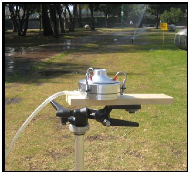
Figura-26 Monitoreo del aire en el momento del riego
