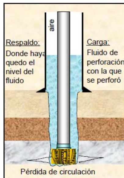
Figura 2.9 - Condiciones de colapso para TR superficial.
