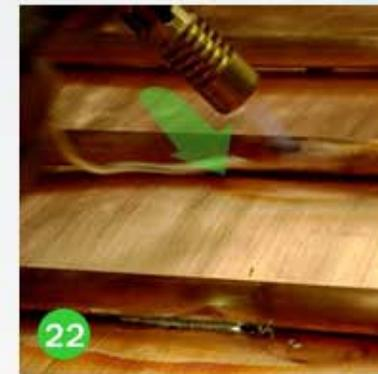
Una completamente el serpentín a la lamina de cobre a lo largo de los tubos.
