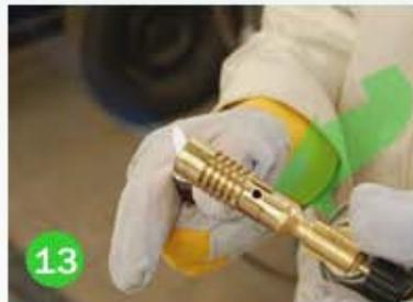
Tome el soplete y enciéndalo, el soplete cuenta con una válvula de ajuste para la entrada de aire, la flama debe ser de color azul.
