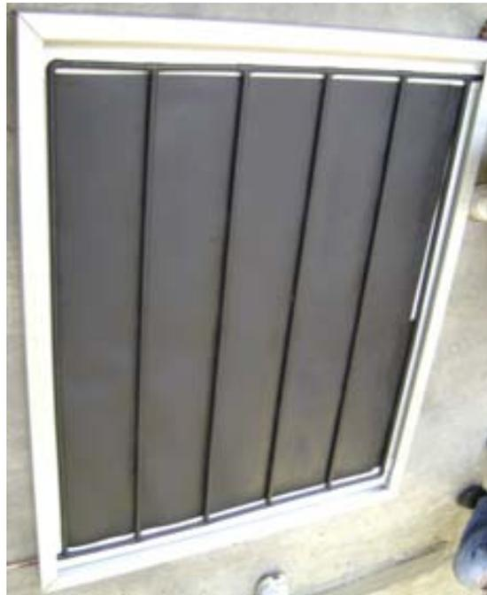
*Figura 8. Marco del colector fijo al triplay y serpentín de cobre.*
