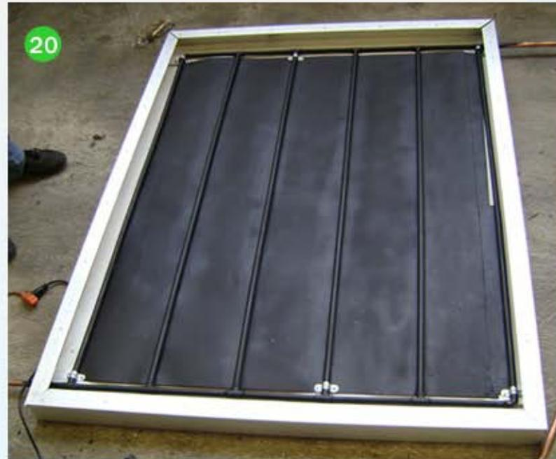
Para finalizar el colector solar, tomamos las pijas y fijamos la tabla blanca al perfil de aluminio, por la parte de atrás-
