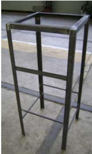
*Figura 10. Base del colector.*
