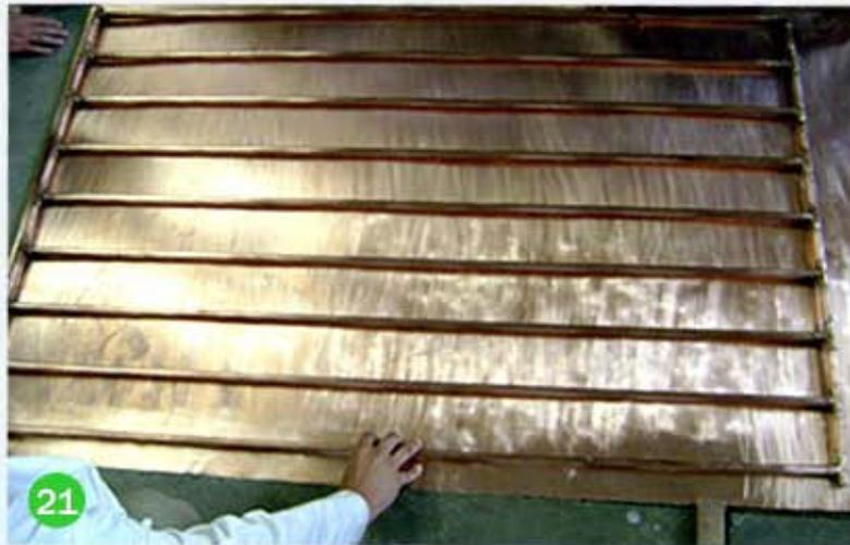
Colocamos la lamina por encima del serpentín, tomamos el martillo y comenzamos a golpear la lamina a lo largo de los tubos hasta formar un canal que ajuste la lamina a la forma de los tubos.
