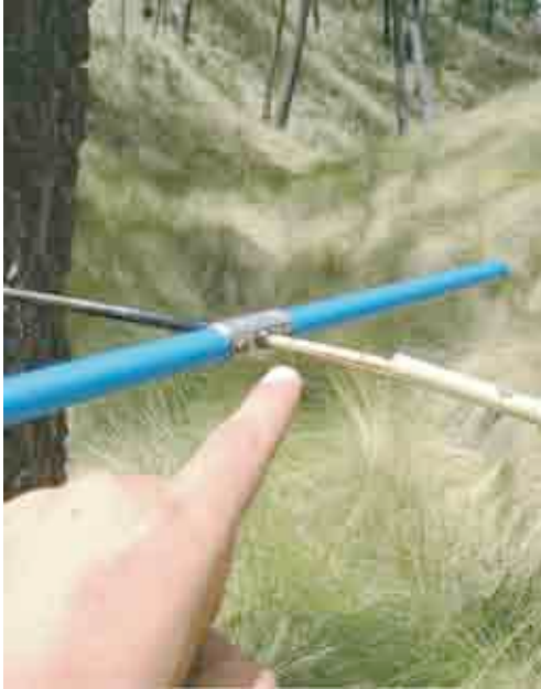
Figura 4.2. Colecta de núcleos con barreno Pressler en Pinus hartwegii .
