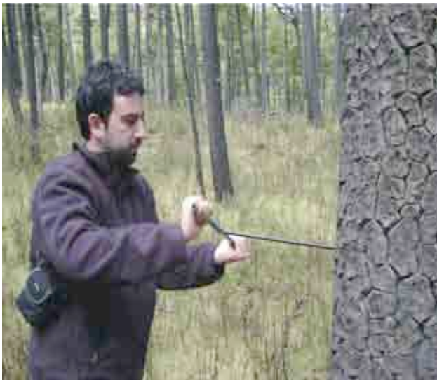
Figura 4.3. Extracción de crecimientos a la altura del pecho (1.35m), para obtener la mayor información posible.
