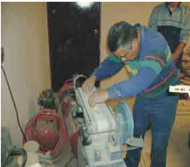
Figura 4.5. Lijado y pulido de muestras para análisis.
