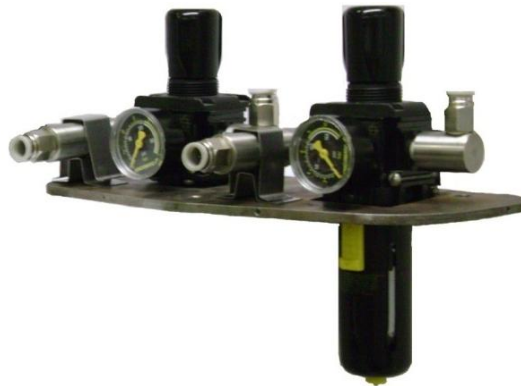
Figura 3.2 Subensamble del sistema de potencia neumática.
