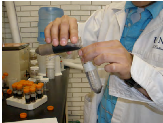
Figura 7. Extracción de ácidos húmicos y fúlvicos en el laboratorio de Edafología y Nutrición Vegetal, FES Zaragoza, UNAM.
