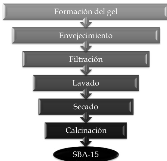
Figura 2.1. Secuencia de etapas en la síntesis del SBA-15.
