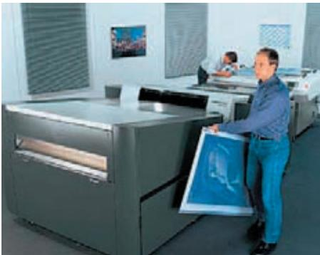
Se parte de un archivo de computadora, del cual electrónicamente se hacen las impositones. Se hacen pruebas de color digitalmente, de dos lados y con impositones. La placa es expuesta directamente a través de una máquina digital.
