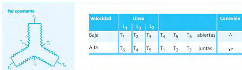
Figura 2: Configuración 25 de conexiones dos velocidades un solo devanado.
