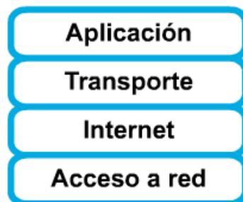
Figura 1.5 Modelo TCP/IP
