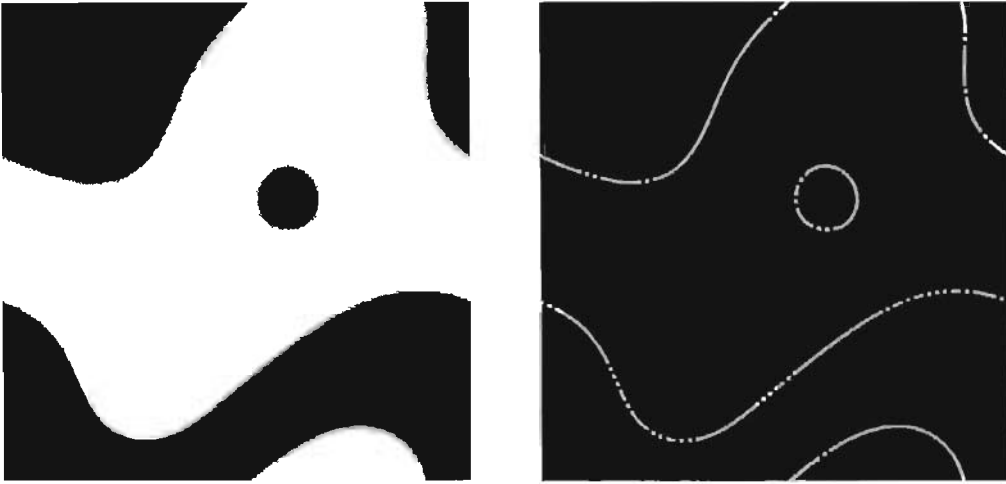
Figura 3.14: Patrones para el caso E generados por la solución numérica de las ecuaciones (2.5). La imagen de la izquierda corresponde al patrón del campo u(x, y) y la imagen de la derecha al campo v(x, y) .
