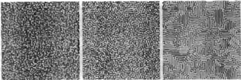
Figura 1.3: Resultados de patrones obtenidos por el método de relajación. La estructura del patrón de celdas (hacia la izquierda de la figura). corresponde al parámetro de temperatura T = 2 . El proceso de ordenamiento para el patrón de celdas (el centro de la figura) inicia en T = 0.8 . Y el patrón de rayas (hacia la derecha de la figura) es para T = 0.1 (figuras tomadas de [18]).
