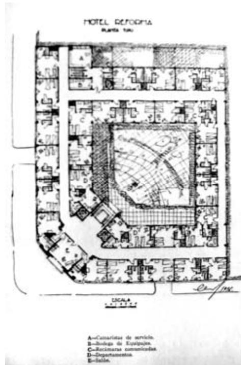
Planta del basamento y planta tipo del Hotel Reforma
