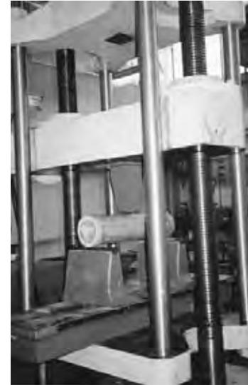
Foto g Prueba de flexión con nodos a los extremos
