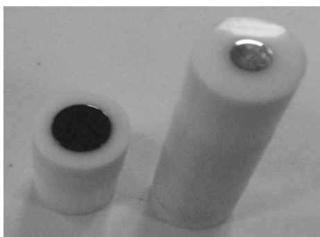
Figura 3. Electrodos de trabajo de carbono vítreo (izquierda) y de acero inoxidable 304 (derecha), empleados para el estudio de electrodeposición de cobre en medio ácido.
