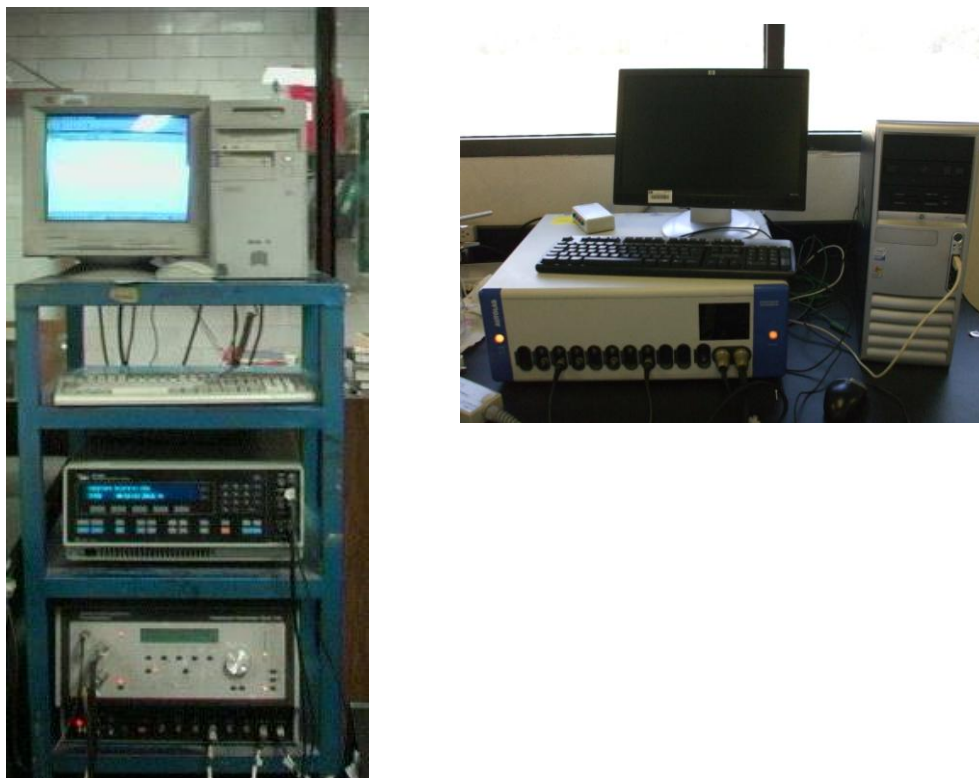
Figura 4. Potenciostato PARC 283 (izquierda) y potenciostato Autolab PGSTAT30 (derecha) empleado para imponer las perturbaciones eléctricas en un arreglo de tres electrodos.
