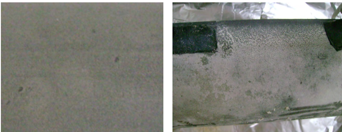
Fig. 3.4 (b) Depósitos formados sobre el cátodo , resistencia 10 ohm
