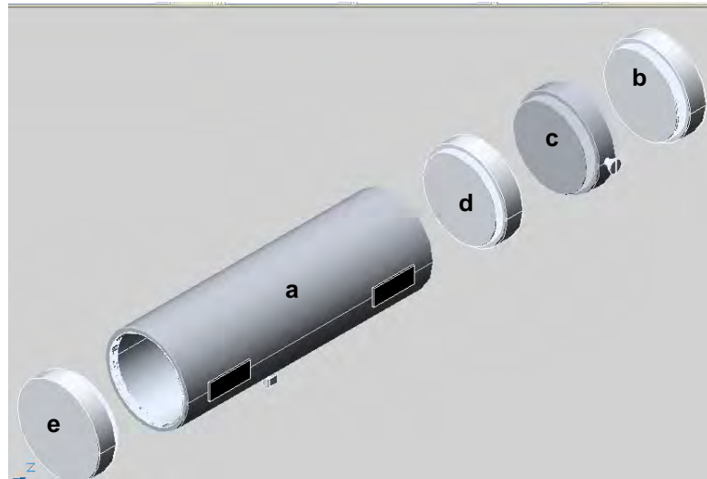
Fig. 2.3. Ensamble de la celda de trabajo
