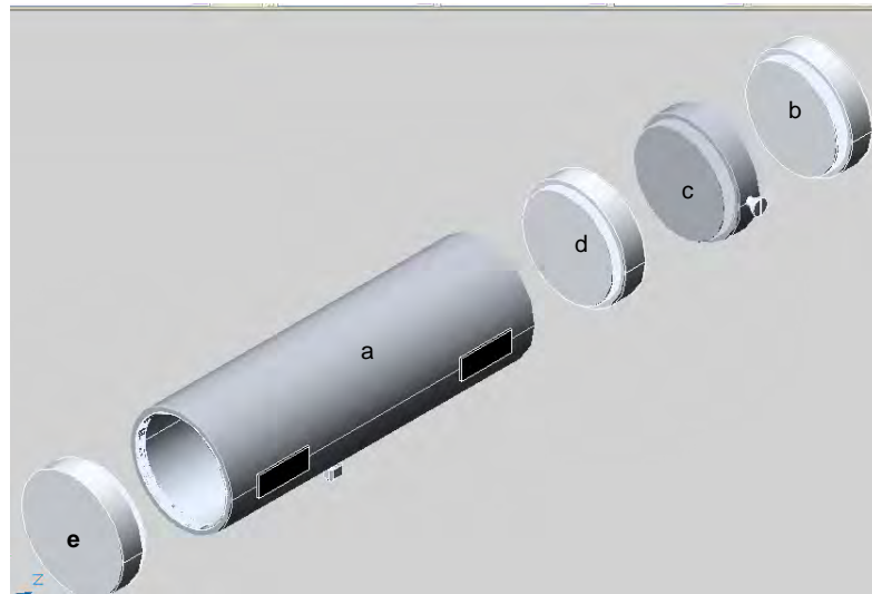
FIGURA 3 – Ensamble de las diferentes partes de la celda electroquímica
