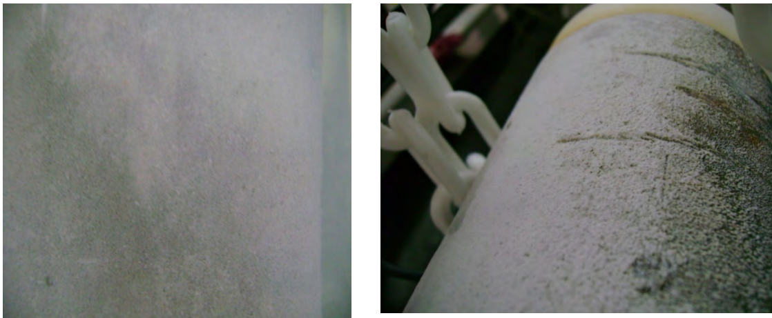
Fig. 3.4 (a) Depósitos formados sobre el cátodo , resistencia 1 ohm
