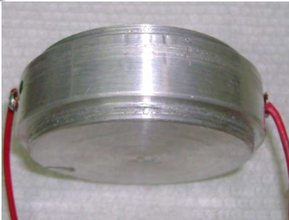
Figura 2.5 Ánodo de aluminio con las conexiones de cable
