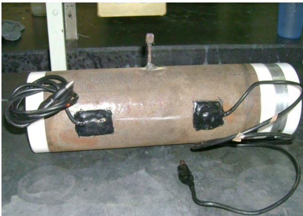
Figura 2.4 Cátodo con las conexiones de cable en los extremos
