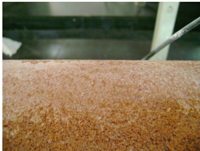
Fig. 3.4 (d) Depósitos formados sobre el cátodo , resistencia 300-100 ohm
