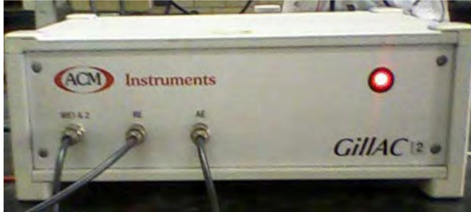
Fig. 2.5 Instrumento de medición para las pruebas electroquímicas.
