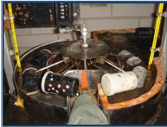
Figura 44. Equipo para termociclado
