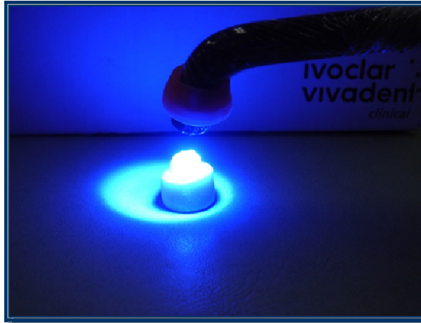
Figura 39. Polimerización de la muestra.
