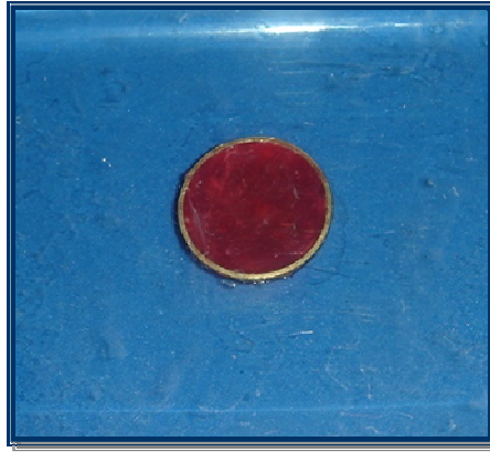
Figura 27. Cera con 1.24 mm de espesor
