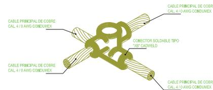
CONEXIÓN CABLE DE PASO TIPO \"X\"
